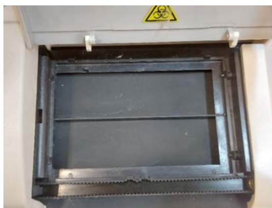
شکل ۲. محل قرارگیری پلیت در دستگاه خوانش الیزا
