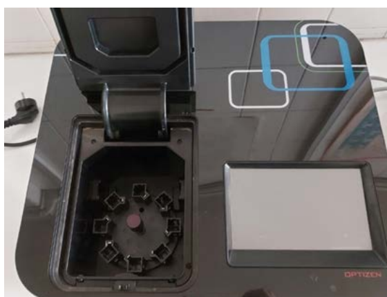
شکل ۳. دستگاه اسپکتروفتومتر و محل قرارگیری کووت‌ها در دستگاه
